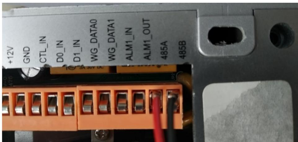
由于控制器外部接线端子没有引出 RS485 接口，因此，需要复用 2 个“常闭”接线端子，并配合控制器内部跳线来实现。端子作为 485 接口用：RS485A、RS485B（跳线图一）；端子作为 SP 接口用：喇叭正极、负极（跳线图二）；端子作为“常闭”接口用：不用任何跳线。
