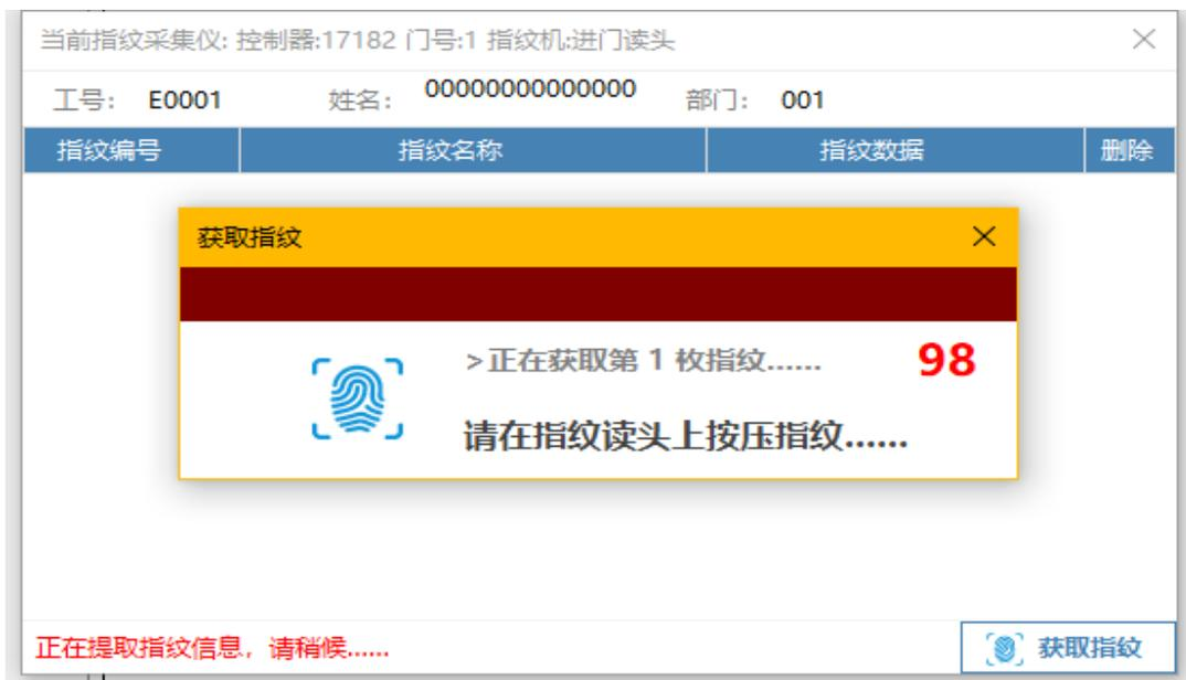
出现界面后，点击获取指纹，前端指纹机上同时提示按压指纹，15 秒内无操作则超时自动结束。
